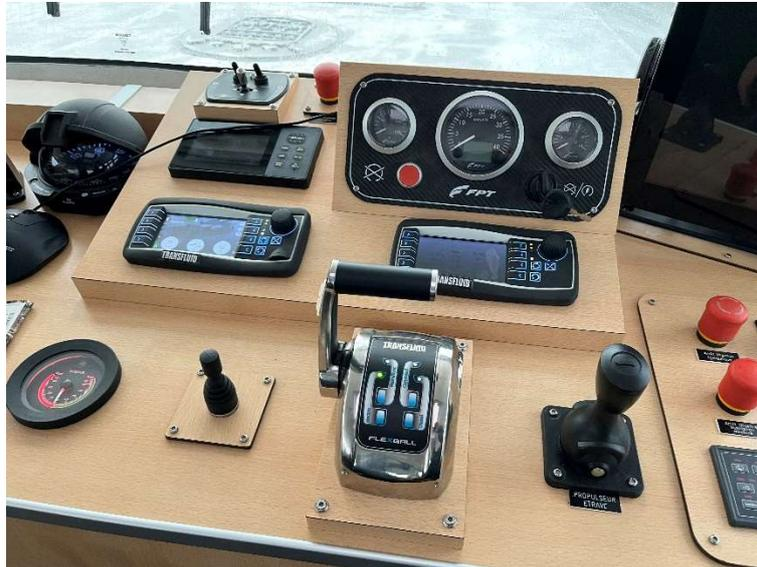
Le contrôle du système se fait à travers d'une manette unique très simple d'utilisation qui permet de piloter les moteurs diesels et électriques avec un passage d'un mode à l'autre rapide et intuitif.
